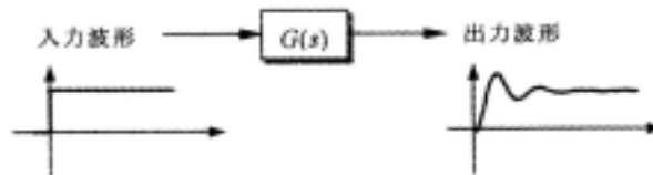
図 5.4 ステップ応答の概念図 5)
